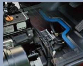
Neben dem Gummidämpfer zwischen Rahmen und Lenkachse erreichen der Verbundmotordämpfer und der vollschwimmende Antriebsstrang eine flexible Verbindung zwischen Rahmen und Antriebssystem, wodurch Fahrvibrationen des Antriebssystems erheblich reduziert werden.
