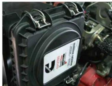
Der CUMMINS-Motor verwendet einen speziellen Luftfilter, der den Lufteinlasswiderstand drastisch reduzieren kann und mit einem Druckalarm ausgestattet ist, um die Wartungszeit zu gewährleisten.
