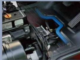
Neben dem Gummidämpfer zwischen Rahmen und Lenkachse erreichen der Verbundmotordämpfer und der vollschwimmende Antriebsstrang eine flexible Verbindung zwischen Rahmen und Antriebssystem, wodurch Fahrvibrationen des Antriebssystems erheblich reduziert werden.
