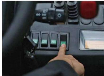
Das Differential wurde speziell für raues Gelände entwickelt und verfügt über eine manuelle Differentialsperre, die bei schlechtem Wetter und rauen Betriebsflächen maximale Traktion bieten kann, um einen Leistungsverlust beim Durchrutschen eines Rads zu vermeiden.
