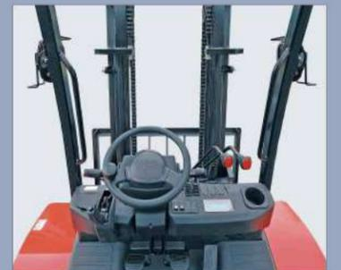
Neu gestaltetes Lenkrad und Bremssystem ist einfach zu bedienen, bietet volle Kontrolle
