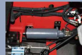
Im Bremssystem befindet sich ein Energiespeicher. Wenn der Motor abgestellt ist, kann er auch mehr als die vierfache Notbremskraft liefern.
