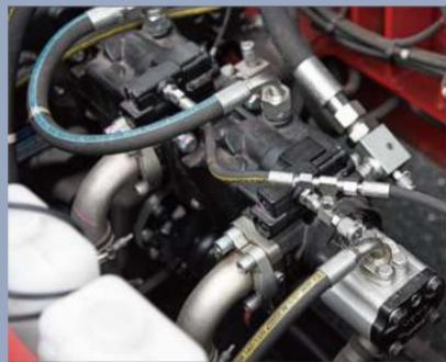
Das Load-Sensing-Hydrauliksystem kann einen hohen Wirkungsgrad und Energiespareffekt erzielen. Durch Absenkung der Arbeitstemperatur des Hydrauliköls kann die Lebensdauer von Hydraulikkomponenten und Dichtungen verlängert werden.
