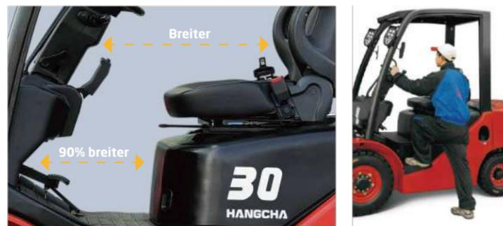
Der zusätzliche Fußraum reduziert die Ermüdung des Fahrers erheblich. Die neue, weiter geöffnete, rutschfeste Stufe macht das Ein- und Aussteigen einfacher und sicherer.
