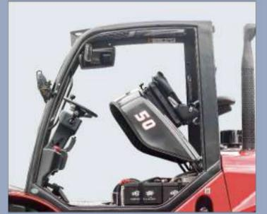
Der leicht zu öffnende Haken ermöglicht einen schnellen Zugang zum Motorraum
