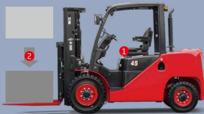
1. Das Anwesenheitserfassungssystem des Fahrers umfasst eine Hebe/Kipp- und Fahrsperrfunktion. Wenn der Fahrer den Sitz verlässt, sperrt das System automatisch das Heben/Kippen und deaktiviert die Bewegung, um die Sicherheit zu gewährleisten.
