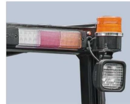
Das neue Effizienzbeleuchtungssystem verwendet LED-Leuchtmittel und einen neuartigen Reflektor, um den Energieverbrauch zu senken und die Beleuchtungsleistung erheblich zu verbessern.
