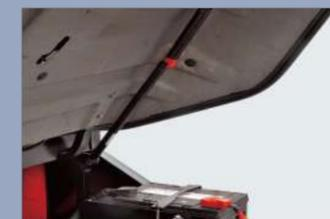
Die Verriegelung des Motorhaubendämpfers und der Feststellbremse tragen zur Sicherheit bei.
