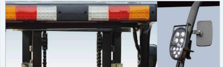
Das neue effiziente Beleuchtungssystem verwendet LED-Leuchtmittel und einen neuartigen Reflektor, um den Energieverbrauch zu senken und die Beleuchtungsleistung erheblich zu verbessern.
