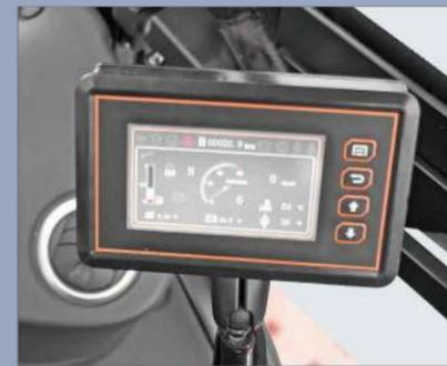
Das neu entwickelte LCD-Instrument verfügt über umfassendere Funktionen und eine stabilere Leistung. Es kann wichtige Informationen wie den Staplerstatus und den Motorzustand anzeigen, damit der Bediener den Staplerstatus intuitiver verstehen und die Wartung erleichtert werden kann.
