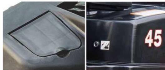
Die Abdeckung des Panels kann zur Überprüfung der Bremsflüssigkeit leicht angehoben werden.
