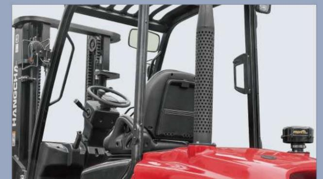
4. Aufgrund des größeren Abstandes zwischen den inneren Masten bietet der Gabelstapler eine breite Sicht nach vorne.
