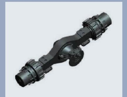
KESSLER Hochleistungs Antriebsachse, zweistufige Übersetzung; Nassbremse, wartungsfrei; Parkbremse mit hydraulischer Entsicherungsfeder, sicher und zuverlässig
