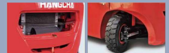
Der kombinierte Kühler mit zusätzlicher Kapazität mit Serpentinewelle und der optimierte Wärmeableitungskanal verbessert die Wärmeleitfähigkeit und die Zuverlässigkeit des Motors, auch bei Hochleistungsanwendungen.
