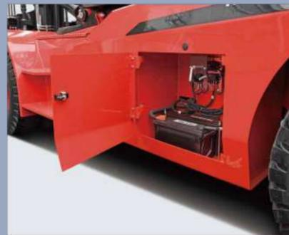
Das Batteriefach lässt sich zur einfachen Wartung leicht öffnen.
