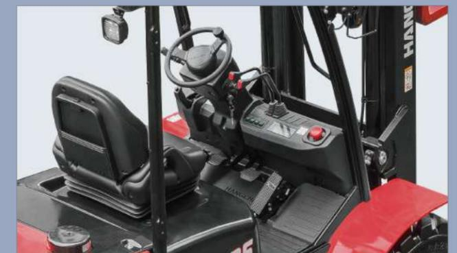
2. Der zusätzliche Fußraum reduziert die Ermüdung des Fahrers erheblich. Die rutschfeste Stufe erleichtert das Ein- und Aussteigen. Das neu gestaltete Lenkrad und Bremssystem sowie die einfach zu bedienenden Hebel sorgen für ein umfassendes Handling Operation.
