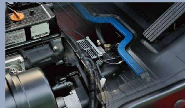
1. Neben dem Gummidämpfer zwischen Rahmen und Lenkachse erreichen der Verbundmotordämpfer und der vollschwimmende Antriebsstrang eine flexible Verbindung zwischen Rahmen und Antriebssystem, wodurch Fahrstörungen des Antriebssystems erheblich reduziert werden. system are significantly reduced.
