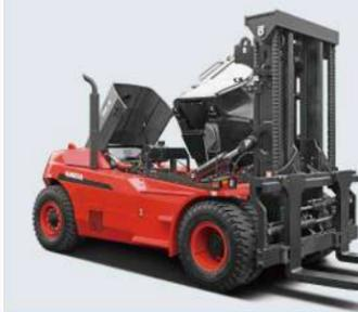
Dank des einzigartigen Designs kann die Kabine ohne Werkzeug gekippt werden, wichtige zu wartende Bauteile können leicht durch Kippen der Kabine erreicht werden, ein maximaler Zugänglichkeit ist möglich.
