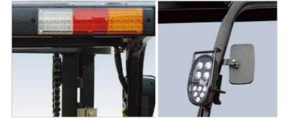
Das neue Effizienzbeleuchtungssystem verwendet LED-Leuchtmittel und einen neuartigen Reflektor, um den Energieverbrauch zu senken und die Beleuchtungsleistung erheblich zu verbessern.
