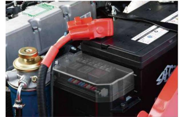
Die Verwendung einer neuen Generation von integrierten Schaltkästen erleichtert die Wartung und Reparatur, das Layout wird einfacher und bietet eine bessere Wasserdichtigkeit.
