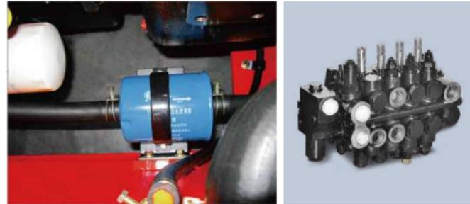
Bremsflüssigkeit und Lenkflüssigkeit sind getrennt und stören sich nicht gegenseitig. Das dynamische Load-Sensing-Lenkensystem wird übernommen, um Energie zu sparen.
