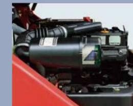
Der neue Staufilter und die Dichtung mit Sicherheitsfilter ist langlebig. Sie sind beständig gegen Korrosion und Stöße und bieten bessere Filtrationseffizienz und Ansaugwiderstand.
