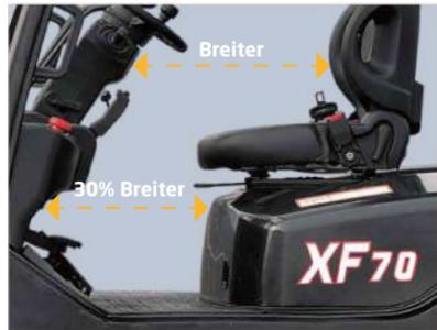
Der zusätzliche Fußraum reduziert die Ermüdung des Fahrers erheblich. Die neue, weiter geöffnete, rutschfeste Stufe macht das Ein- und Aussteigen einfacher und sicherer.
