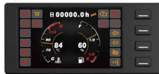
Interaktive Instrumententafel: Das Instrument verfügt über ein 4,0-Zoll-Farb-LCD-Display mit vier interaktiven Tasten und eine CAN-Bus-Kommunikationsfunktion. Das Kommunikationsprotokoll ist mit den Standards CANopen und SAE J1939 kompatibel.
